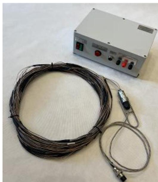
Рисунок 4 – ЦТПТ и пульт для проверки термоподвесок
