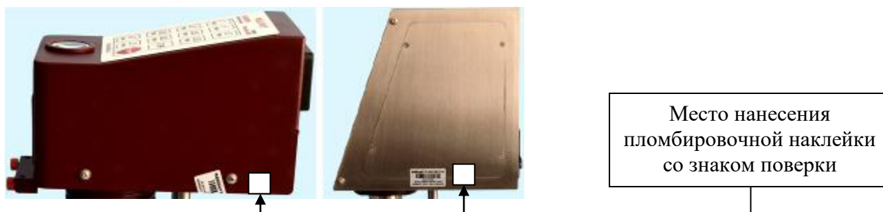
Р и с у н о к 3 – Место нанесения пломбировочной наклейки со знаком поверки
