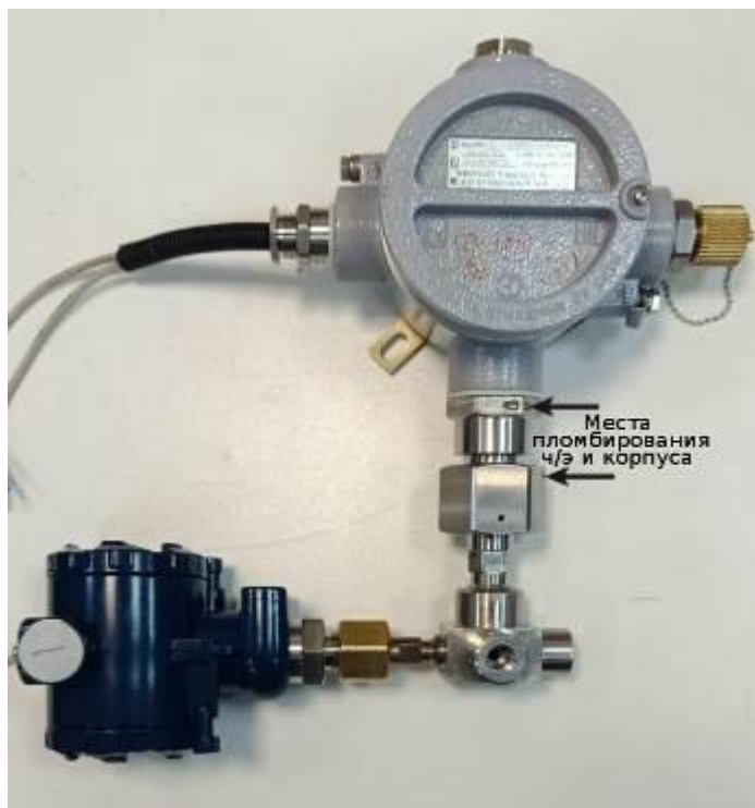
б) Исполнение 2 (газоанализатор без дисплея датчиком давления)
