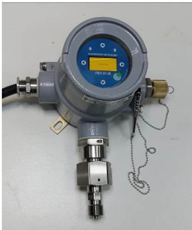
а) Исполнение 1 (газоанализатор с дисплеем)
