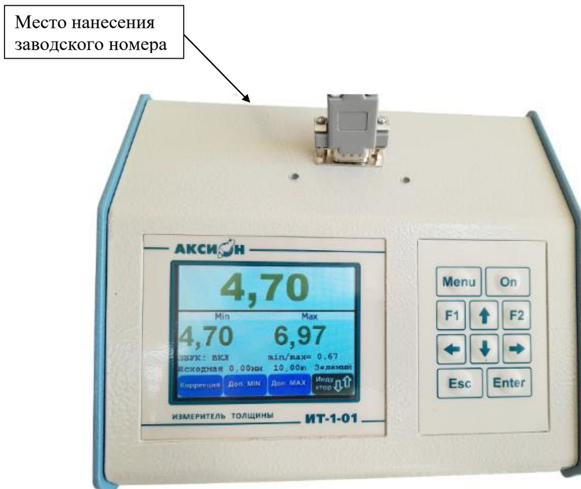
Рисунок 1 – Общий вид измерителя с указанием места нанесения заводского номера
