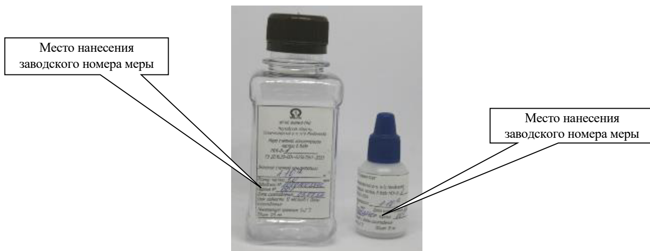
Рисунок 1 – Общий вид мер счетной концентрации частиц в воде МСК-В-1
