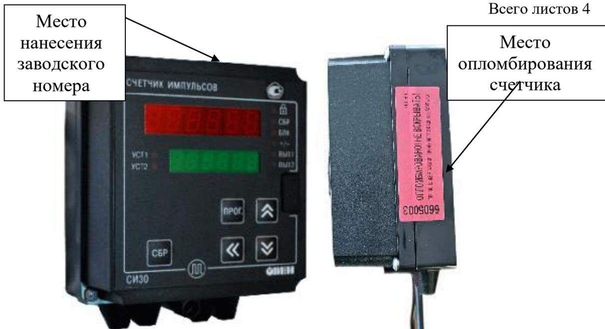
Рисунок 1 – Счетчик импульсов микропроцессорный СИЗ0
