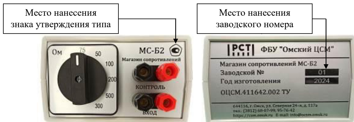
Р и с у н о к 1 – Общий вид магазинов, обозначение мест нанесения заводского номера и знака утверждения типа
