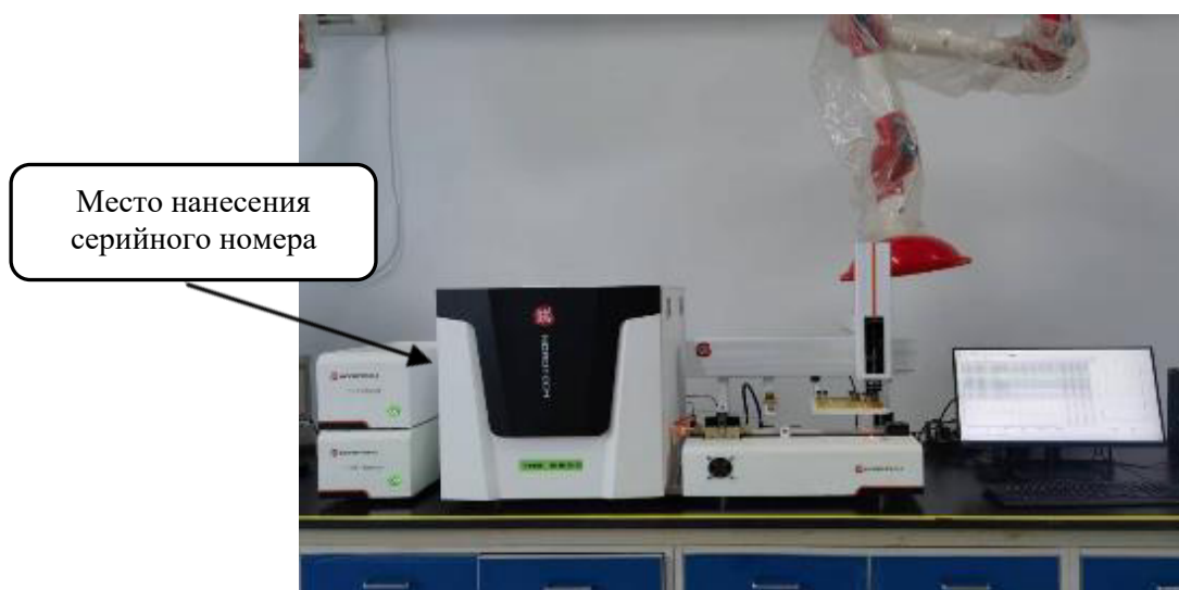
Рисунок 1 – Анализаторы серы и азота PROXILAB (с вертикальным вводом проб), обозначение места нанесения серийного номера
