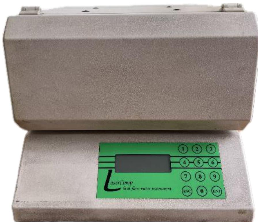
Рисунок 1 – Общий вид прибора для измерения теплопроводности FOX 200
