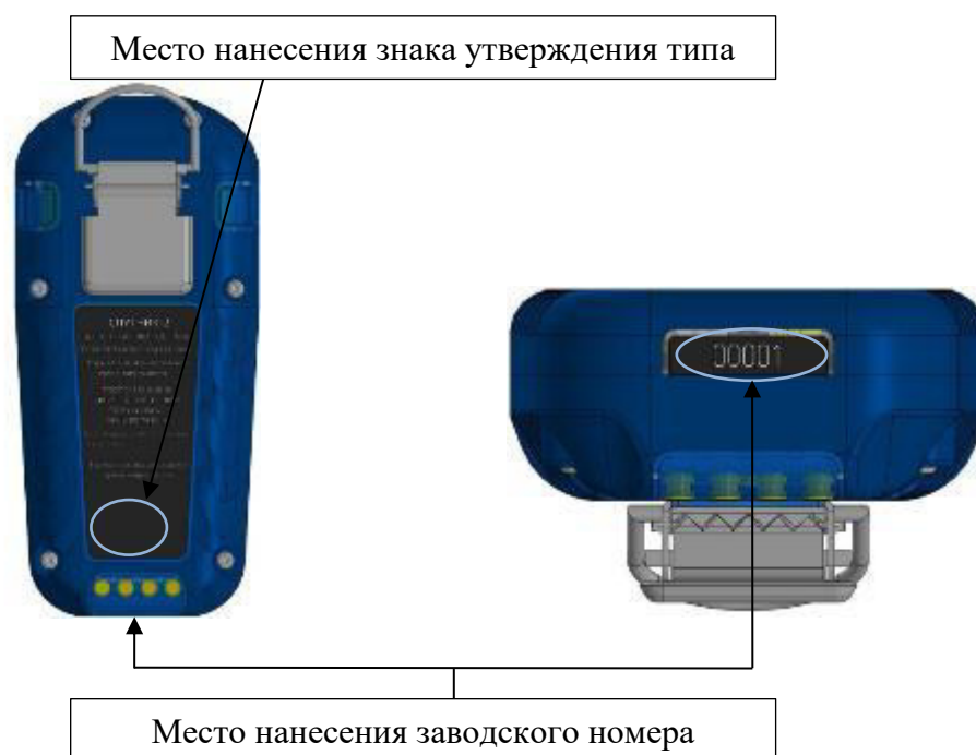
Р и с у н о к 2 – Место нанесения заводского номера и знака утверждения типа
