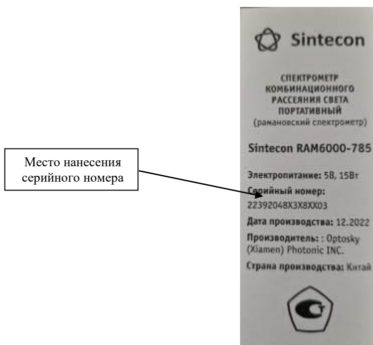
Рисунок 2 – Место нанесения серийного номера на спектрометры комбинационного рассеяния света портативные Sintecon RAM6000
