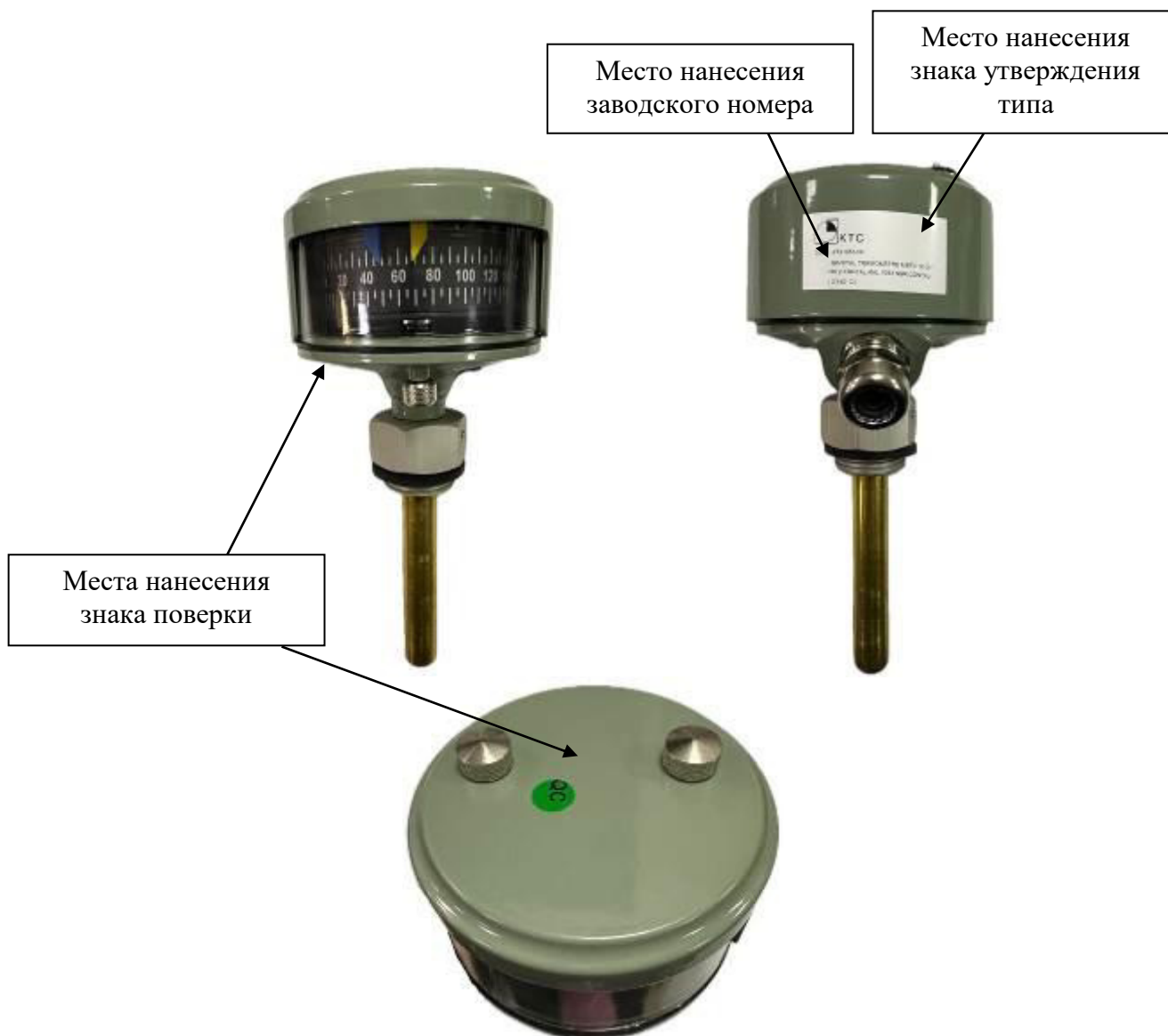
Рисунок 1 – Общий вид термометра с указанием места нанесения знака утверждения типа, места нанесения заводского номера, мест нанесения знаков проверки.
