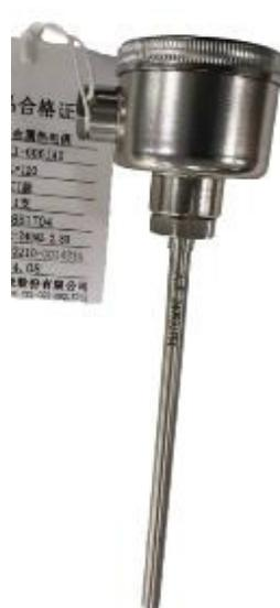
6 – соединительная головка из нержавеющей стали
