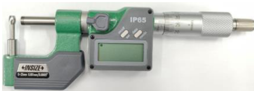
Рисунок 22 – Общий вид микрометров модификации 3561 исполнения 25CA, 50CA, 25DA, 50DA, 25EA, 50EA, 25FA, 50FA
