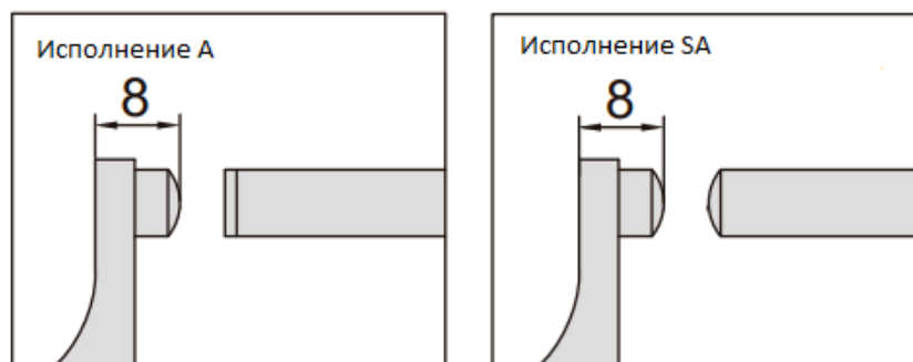
Рисунок 18 – Варианты исполнений измерительных поверхностей микрометров модификаций 3260 и 3560
