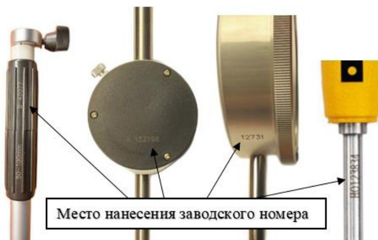
Рисунок 4 – Место нанесения заводского номера на нутромеры
