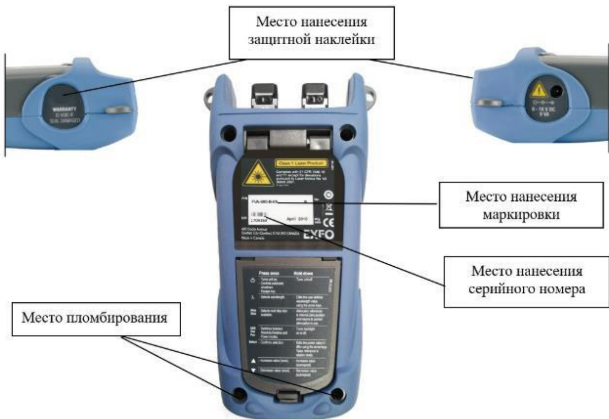
Рисунок 2 – Схема пломбировки от несанкционированного доступа и обозначение места маркировки аттенюатора оптического перестраиваемого FVA-600
