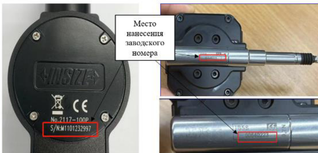
Рисунок 15 – Места нанесения заводских номеров на индикаторы
