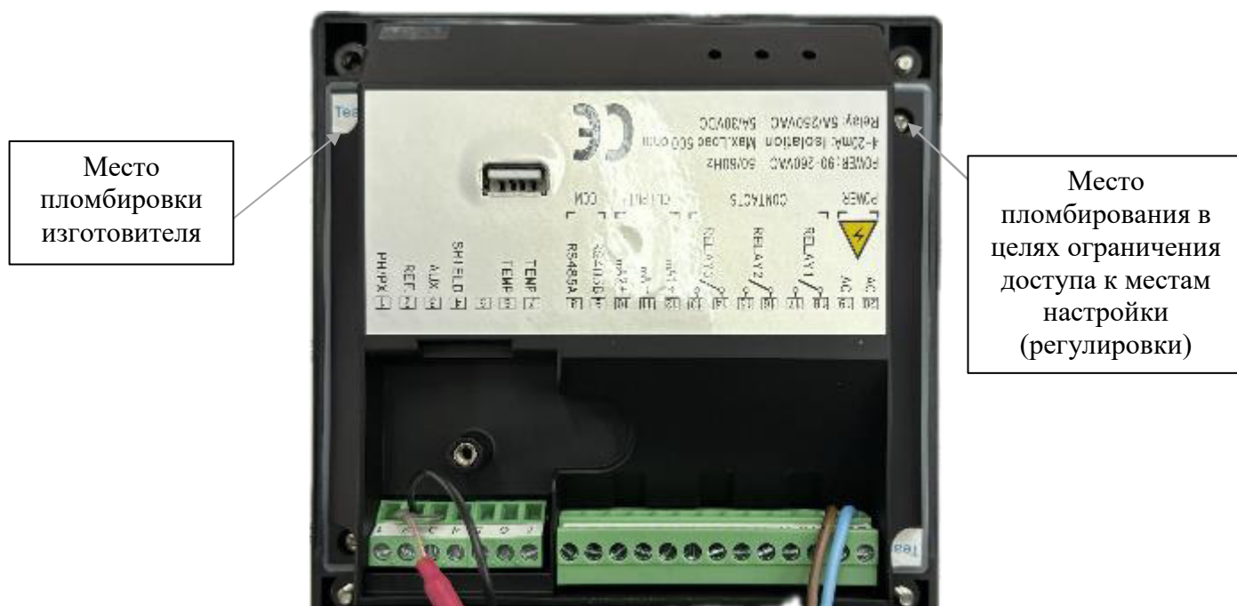
Рисунок 2 – Место нанесения знака поверки и места пломбирования в целях ограничения доступа к местам настройки (регулировки) внутри измерительного преобразователя
