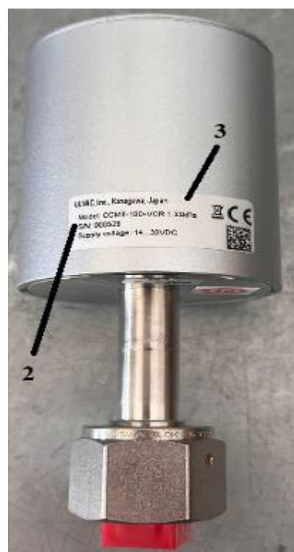
Рисунок 1 – Общий вид преобразователя давления ULVAC CCMT-10D, зав.№ 000528, мест нанесения маркировочной таблички (3), заводского номера (2) и схемы пломбировки от несанкционированного доступа (1)
