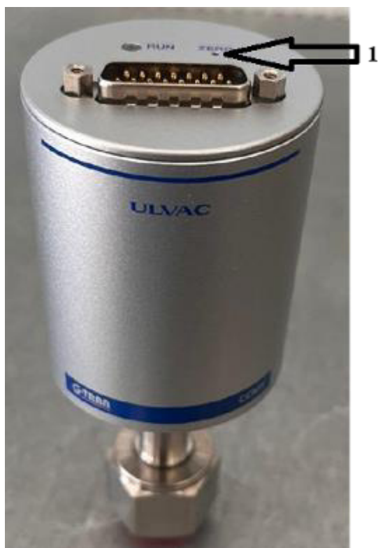
Рисунок 1 – Общий вид преобразователя давления ULVAC CCMT-10D, зав.№ 000528, мест нанесения маркировочной таблички (3), заводского номера (2) и схемы пломбировки от несанкционированного доступа (1)
