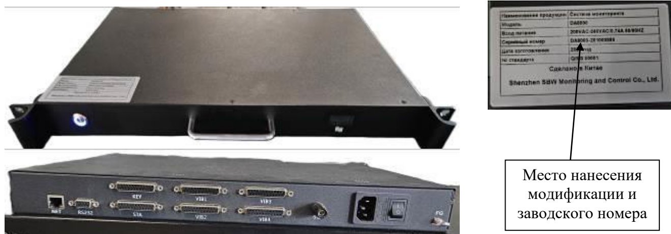
Рисунок 1 – Общий систем мониторинга DA8000 с указанием мест нанесения модификации и заводского номера
