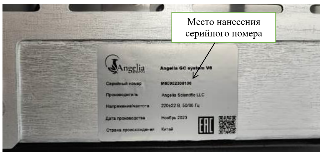
Рисунок 6 – Общий вид маркировочной таблички с указанием серийного номера и её месторасположение на задней панели хроматографа газового Angelia GC System
