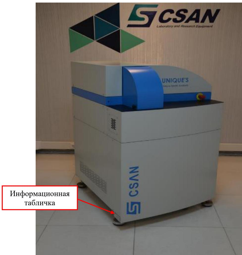
Рисунок 1 – Общий вид спектрометров оптико-эмиссионных Unique's
