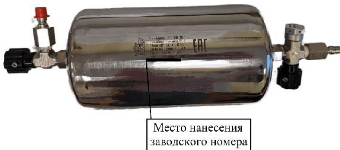
Рисунок 1 – Общий вид пикнометра с указанием места нанесения заводского номера
