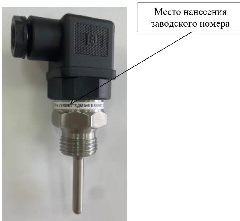
Рисунок 2 – Общий вид термопреобразователей сопротивления платиновых MBT5250R с указанием места нанесения заводского номера
