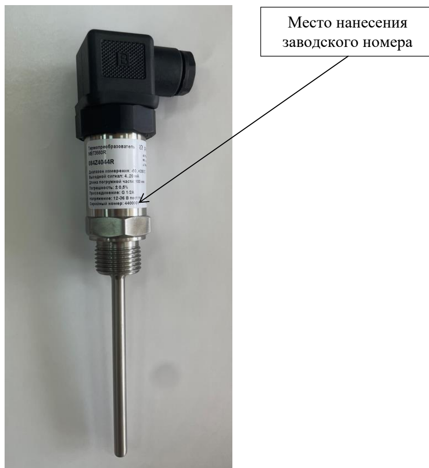
Рисунок 2 – Общий вид термопреобразователей с унифицированным выходным сигналом МВТ3560R с указанием места нанесения заводского номера
