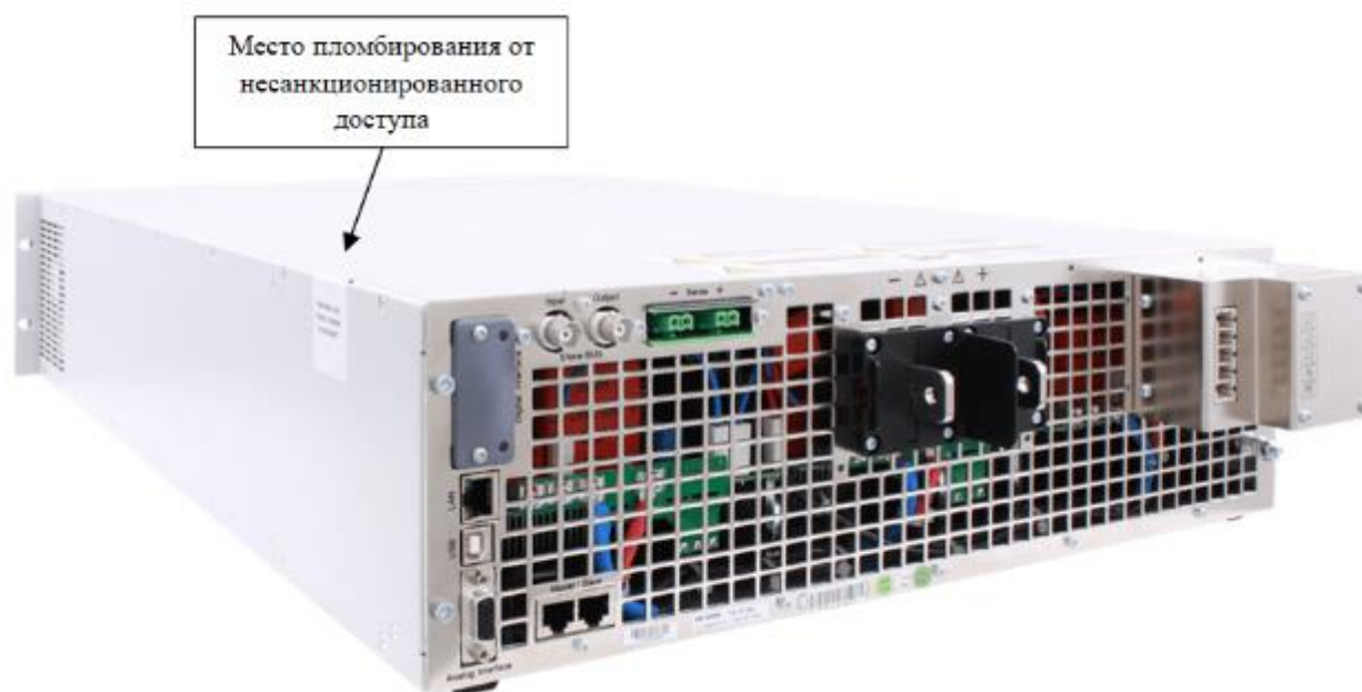
Рисунок 5 – Схема пломбирования от несанкционированного доступа
