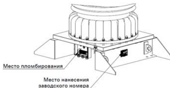
Рисунок 1 – Общий вид трансформаторов, место нанесения заводского номера и место пломбирования
