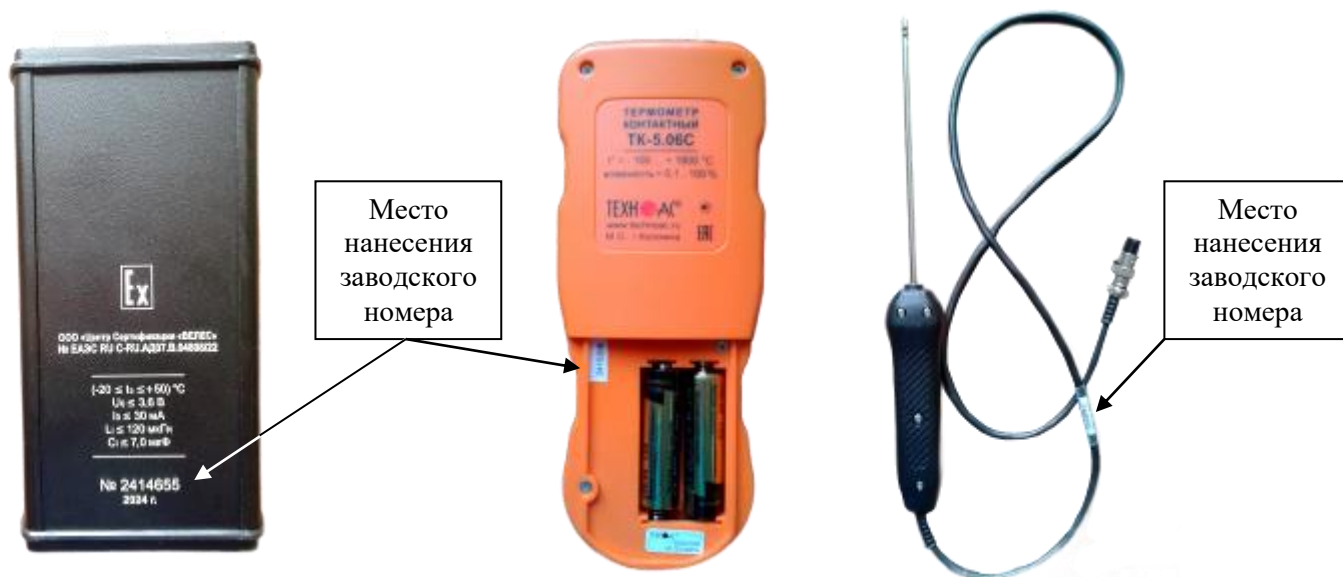
Рисунок 36 – Общий вид термометров с указанием мест нанесения заводского номера
