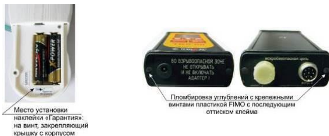
Рисунок 37 – Схема пломбировки от несанкционированного доступа
