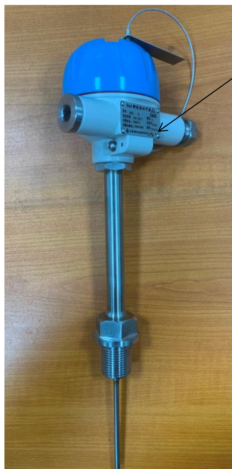
Рисунок 1 – Общий вид термопреобразователей сопротивления WZP с указанием места нанесения заводского номера
