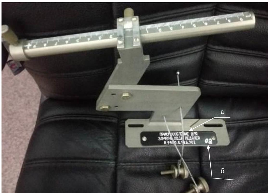
а – место нанесения маркировки, б – место нанесения заводского номера
