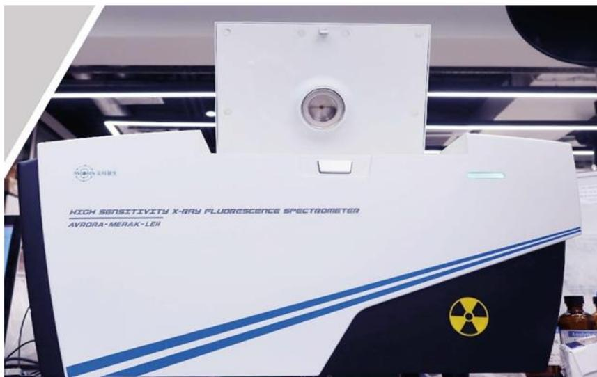
Рисунок 1 – Общий вид анализатора монохроматического энергодисперсионного рентгенофлуоресцентного AVRORA MERAK – LEII
