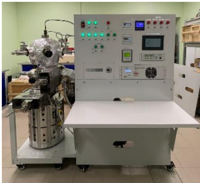
Рисунок 1 – Общий вид установки вакуумметрической эталонной УВЭ-1
