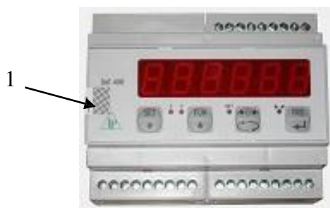
Рисунок 2 – Общий вид и схема пломбировки терминалов DAT 400, (1 – разрушаемая наклейка)
