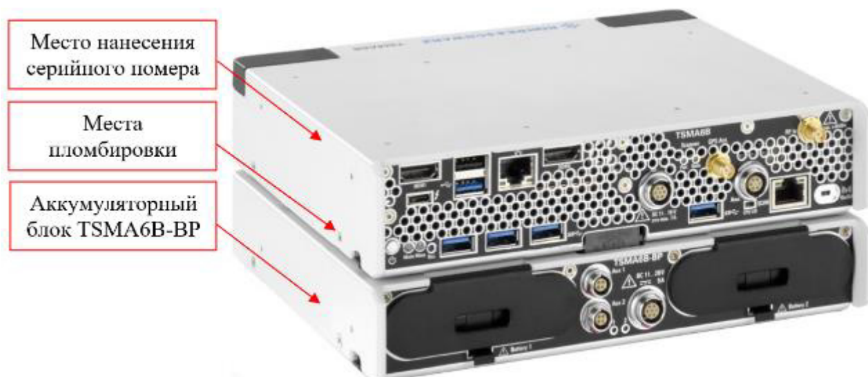
Рисунок 2 – Схема пломбировки от несанкционированного доступа; место нанесения серийного номера; общий вид аккумуляторного блока TSMA6B-VP
