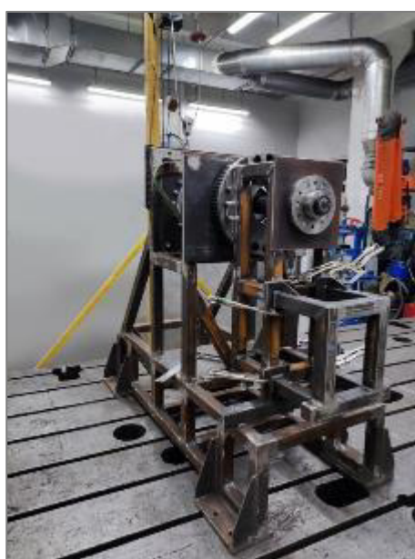
Рисунок 7 – Система измерения крутящего момента
