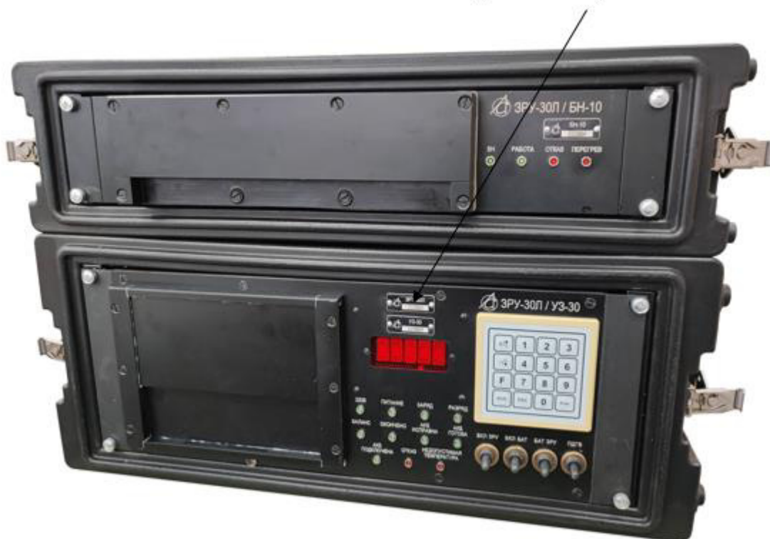
Рисунок 1 – Общий вид ЗРУ и место нанесения заводского номера
