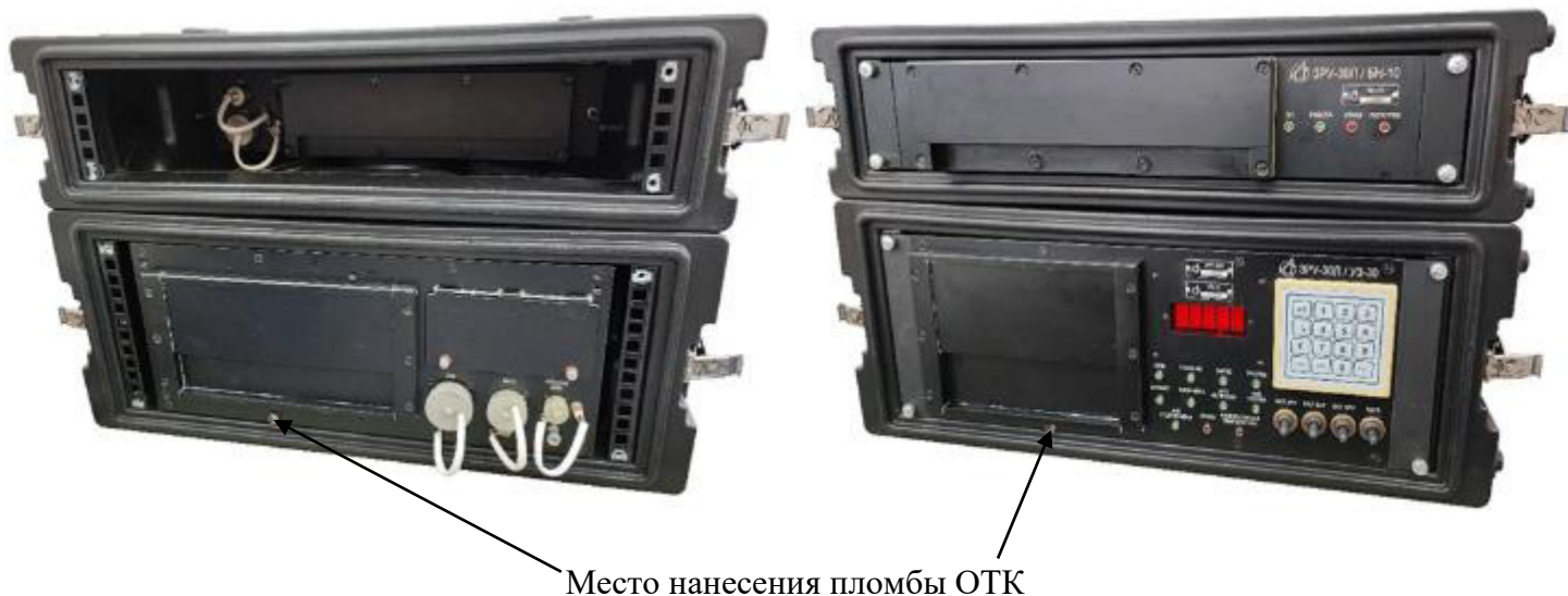
Рисунок 2 – Схема пломбирования от несанкционированного доступа
