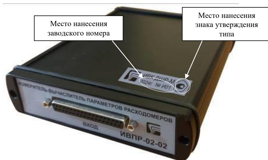
Рисунок 3 – Общий вид ИВПР-02-02 со стороны передней панели с указанием места нанесения заводского номера комплекса ИВК ДШР-М и знака утверждения типа
