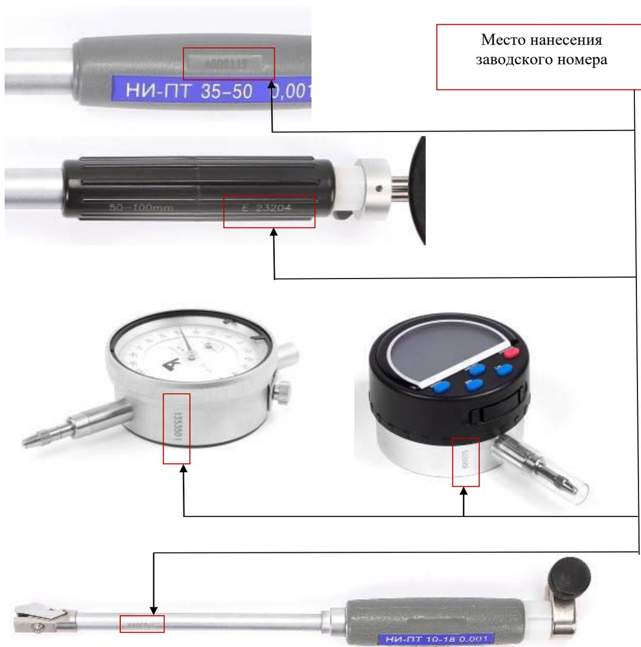
Рисунок 5 – Возможные места нанесения заводского номера
