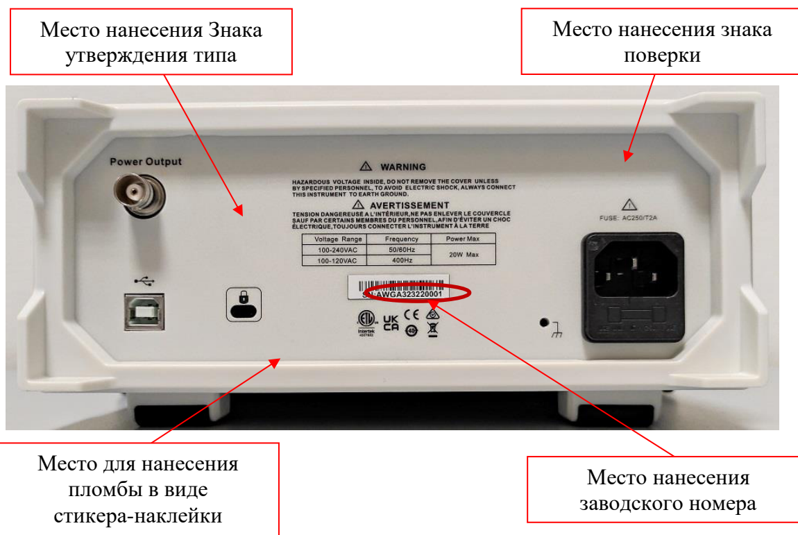
Рисунок 2 – Общий вид (задняя панель) генераторов UNI-T UTG1000X
