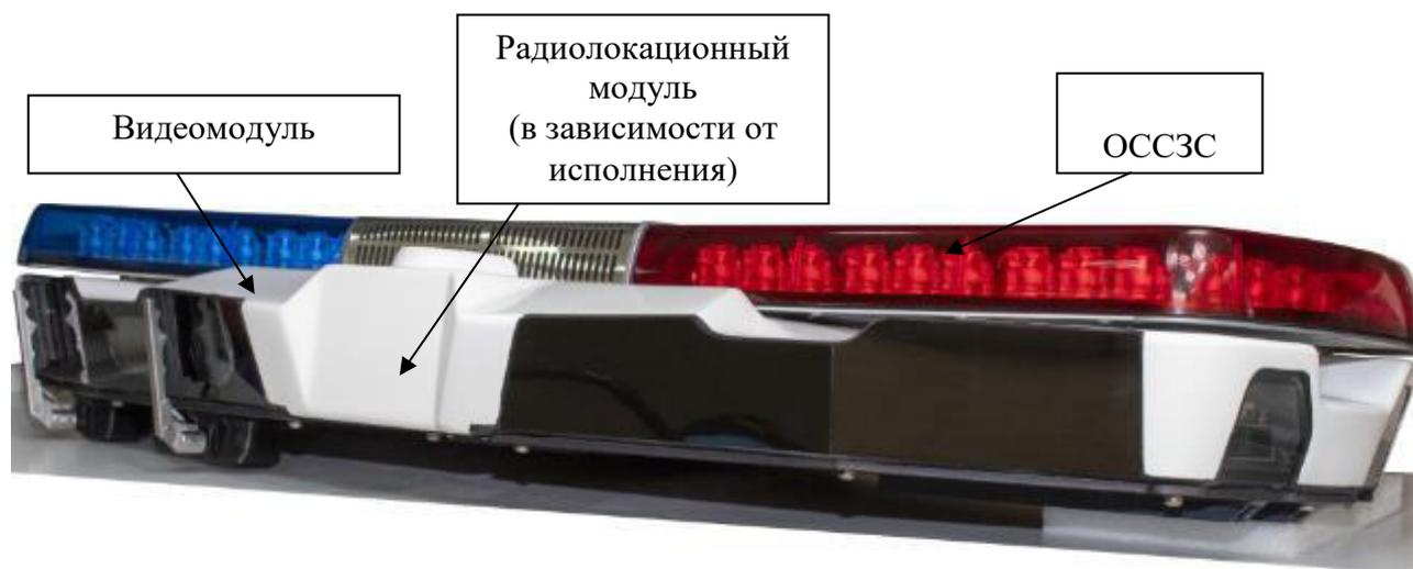
Рисунок 1 – Общий вид комплексов (комплекс с ОССЗС красно-синего цвета)
