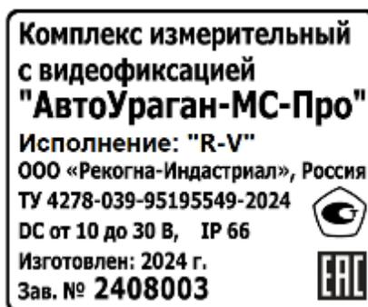
Рисунок 4 – Пример маркировки комплексов и обозначение места нанесения знака утверждения типа
