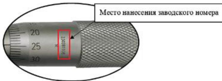
Рисунок 4 – Место нанесения заводского номера
