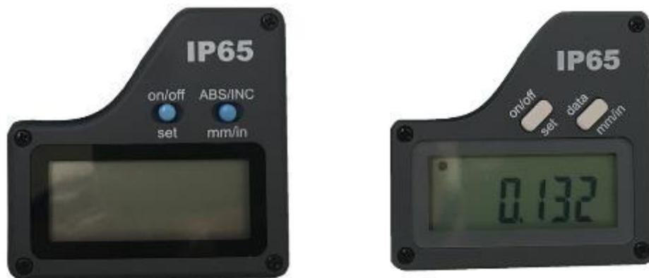
Рисунок 5 – Варианты внешнего вида цифрового отсчетного устройства
