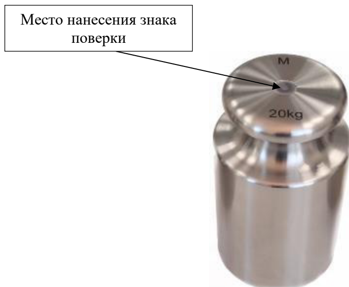
Рисунок 7 – Схема пломбировки от несанкционированного доступа и место нанесения знака поверки
