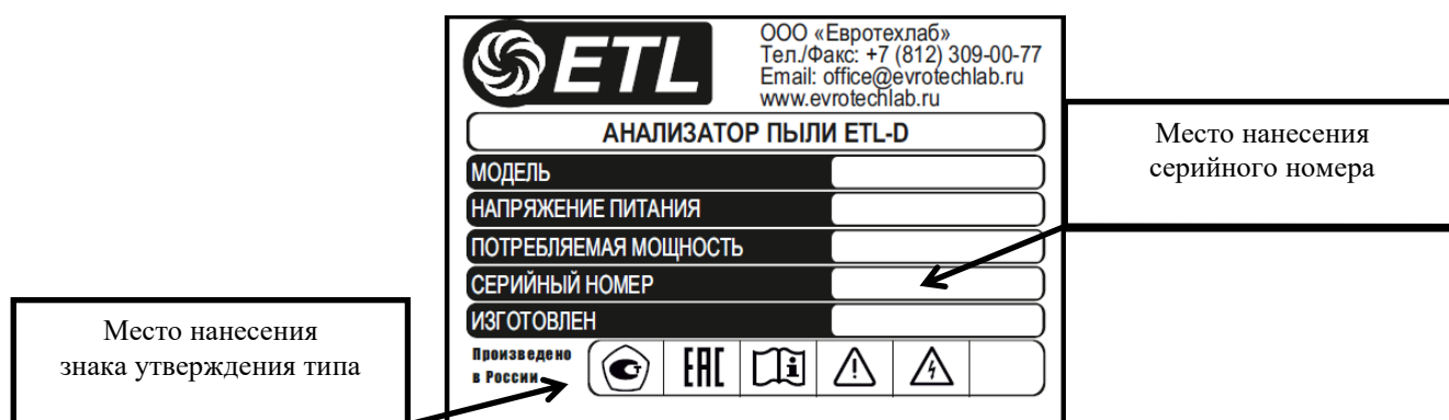
Рисунок 2 – Пример таблички (места нанесения знака утверждения типа и серийного номера)
