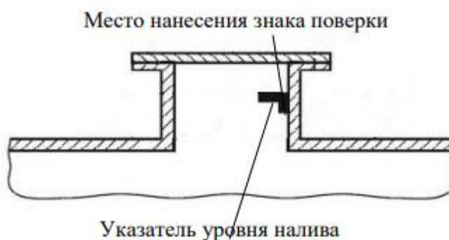
Рисунок 2 - Схема пломбировки от несанкционированного изменения положения уровня налива, обозначение места нанесения знака поверки
