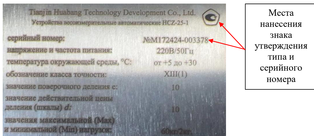
Рисунок 1 – Общий вид маркировочной таблички АВУ с указанием мест нанесения знака утверждения типа и серийного номера
