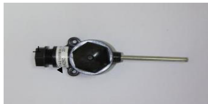
Рисунок 5 - Внешний вид термопреобразователя серии ТМТ-4 исполнения ТМТ-4-2 (1 - место нанесения заводского номера)
