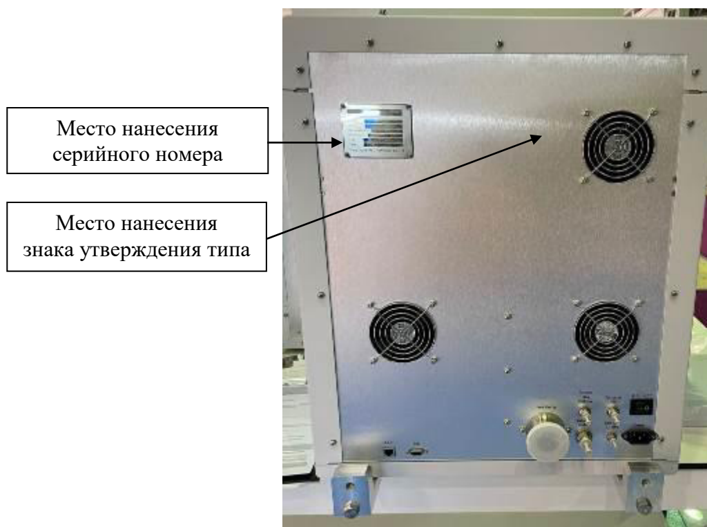
Рисунок 6 – Задняя панель масс-спектрометра тройного квадрупольного с указанием места нанесения серийного номера и места нанесения знака утверждения типа
