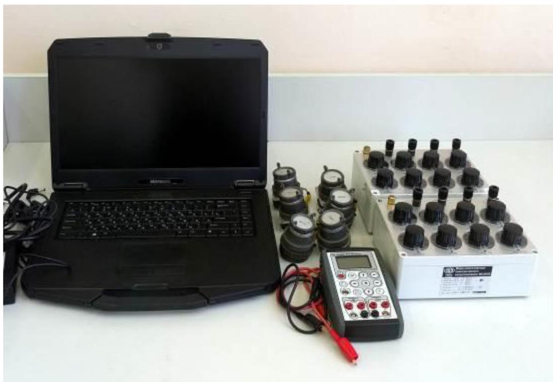
Рисунок 4 – Комплект проверочной аппаратуры СИП 5004-КПА
