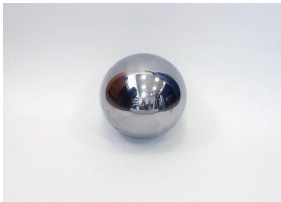
Рисунок 1- Внешний вид меры ЭПР тип «сфера»
