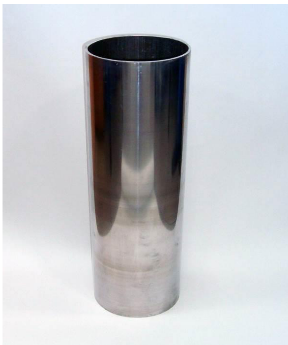
Рисунок 2 – Внешний вид меры ЭПР тип «цилиндр»
