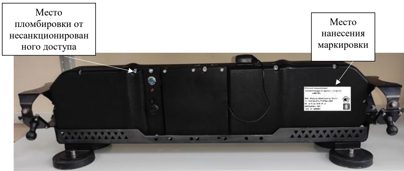
Рисунок 2 – Общий вид комплексов (сзади) с обозначением места пломбировки от несанкционированного доступа
