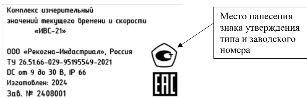
Рисунок 3 – Пример маркировки комплексов и обозначение места нанесения знака утверждения типа и заводского номера
